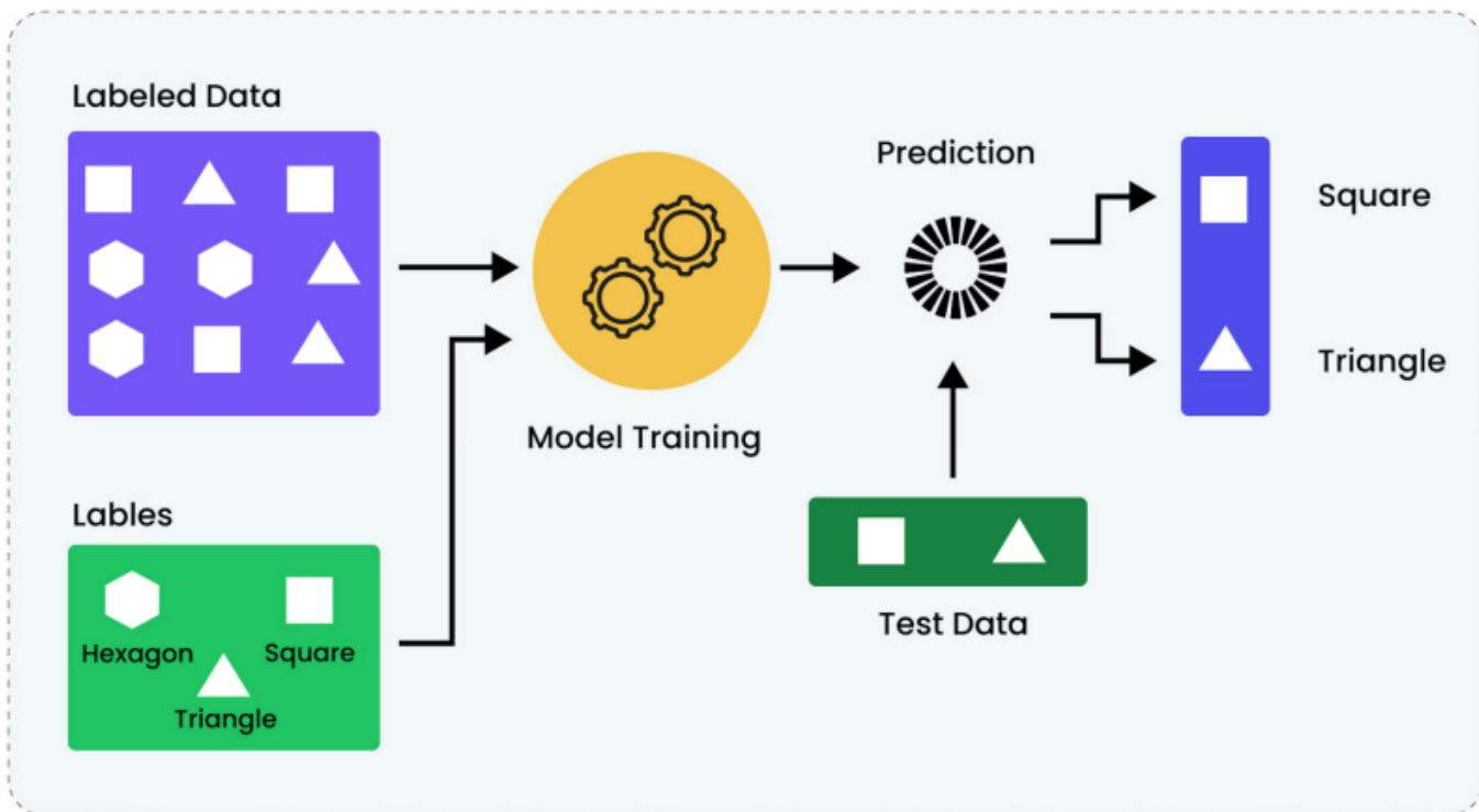
Es funktioniert, indem ein Modell anhand von Beispielen trainiert und seine internen Parameter angepasst werden, um Fehler zu minimieren. Es lässt sich grob in Klassifizierungsaufgaben (Kategorisierung von Daten) und Regressionsaufgaben (Vorhersage numerischer Werte) unterteilen und wird häufig bei den nachfolgenden Aufgaben eingesetzt:
