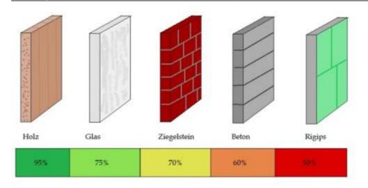
Abbildung 1: Dämpfung des WLAN-Signals in Abhängigkeit des Materials
