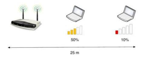
Abbildung 3: Signalverlust infolge von Entfernung
