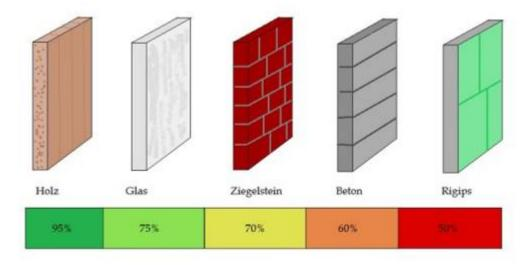
Abbildung 1: Dämpfung des WLAN-Signals in Abhängigkeit des Materials
