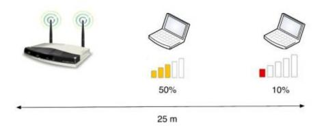
Abbildung 3: Signalverlust infolge von Entfernung
