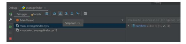
Schaltfläche "Step into" im oberen Teil des Debug-Tool-Fensters Eine weitere Zeile wird im Editor hervorgehoben, da wir den Ausführungspunkt um einen Schritt vorverlegt haben.
