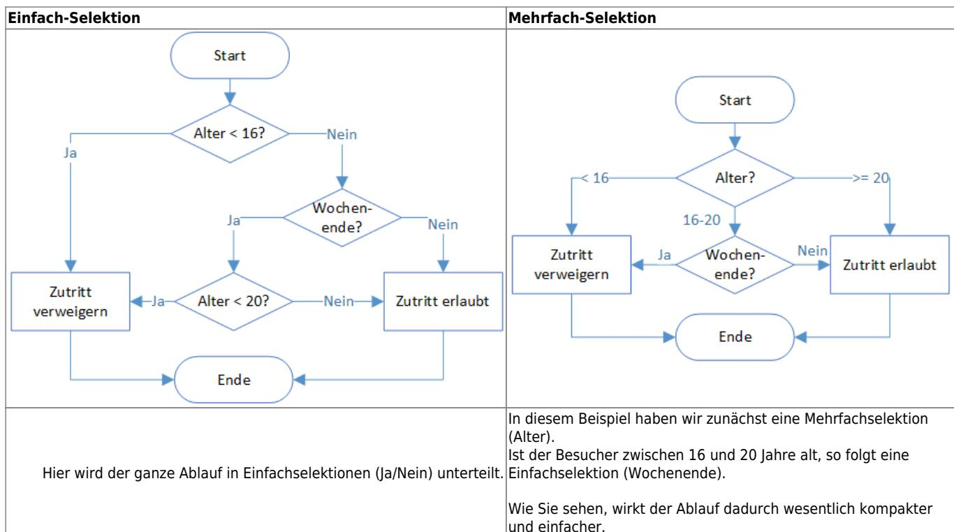
Wenn wir uns streng an die Norm (DIN 66001) halten, so gibt es keine Mehrfachselektionen. Solche Mehrfachbedingungen müssten in mehrere, einzelne Selektionen aufgeteilt werden.
