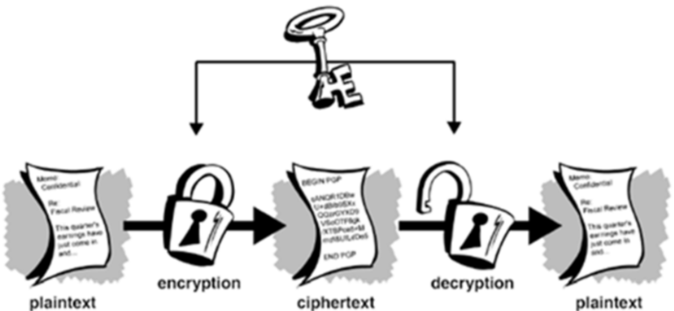
Abbildung 1: Der Ablauf einer symmetrischen Verschlüsselung
