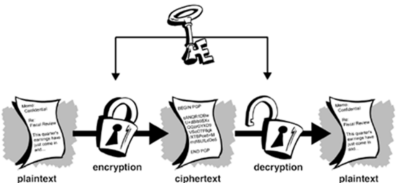
Abbildung 1: Der Ablauf einer symmetrischen Verschlüsselung
