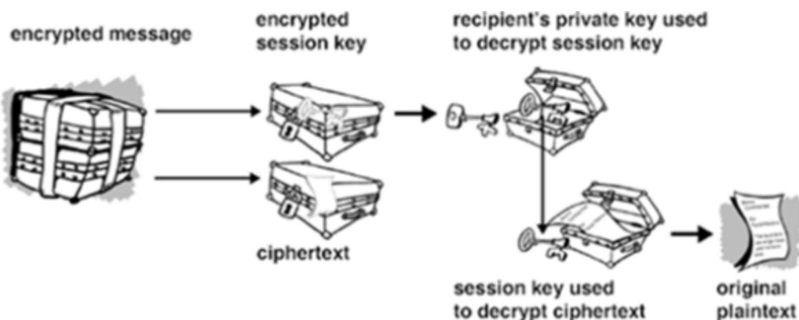
Das nachfolgende Ablaufdiagramm zeigt die Funktionsweise der Hybrid-Verschlüsselung
