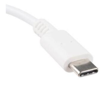
Damit sich der USB-C-Stecker auch für mobile Geräte eignet, hat er eine Abmessung von  $8,25 \times 2,4$  mm. Die Buchse ist  $8,34 \times 2,56$  mm groß. Das entspricht ungefähr einem USB-2.0-Micro-Anschluss, der bei Smartphones verwendet wird. Die korrekte Drehung des Steckers entfällt und der USB-C-Stecker passt auch in der umgekehrten Steckposition.
