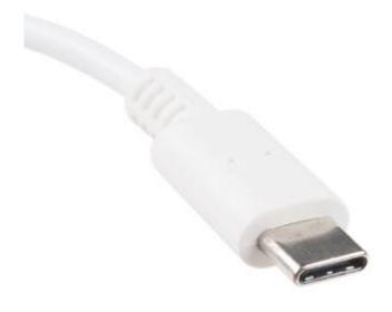
Damit sich der USB-C-Stecker auch für mobile Geräte eignet, hat er eine Abmessung von  $8,25 \times 2,4$  mm. Die Buchse ist  $8,34 \times 2,56$  mm groß. Das entspricht ungefähr einem USB-2.0-Micro-Anschluss, der bei Smartphones verwendet wird. Die korrekte Drehung des Steckers entfällt und der USB-C-Stecker passt auch in der umgekehrten Steckposition.
