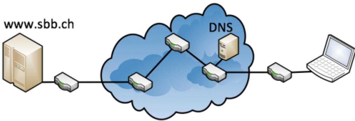
Um die Website der SBB abzurufen, wird beim DNS-Server die Adresse [www.sbb.ch](http://www.sbb.ch) aufgelöst. Somit erhält der Router des Senders die IP-Adresse des Zielservers. Mit dieser Adresse wird nun der Weg zum Server durch den „Dschungel“ des Internets gesucht. Diese Aufgabe fällt weiteren Routern zu. Wie viele Router für den Zugang zu einem Server kontaktiert werden, lässt sich mit den Tool traceroute (Unix, Mac) oder tracert (Windows) verfolgen.
