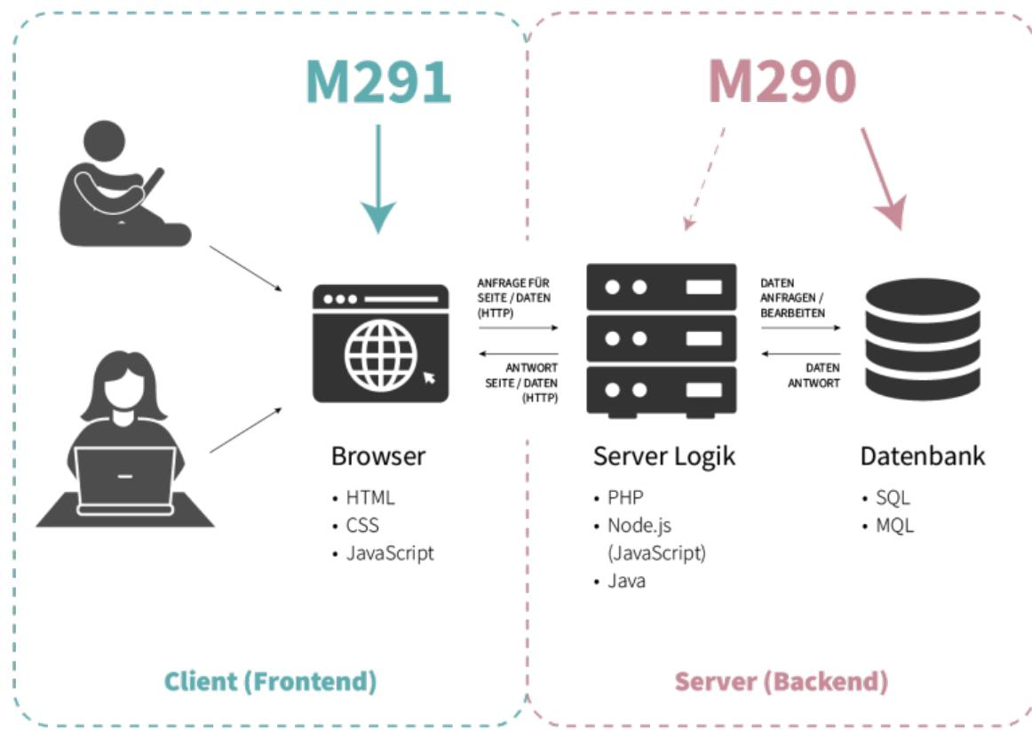
*Client-Server-Modell und Einordnung der zwei Module 290 und 291. M291 (Oberflächen (UIs) mit Webtechnologien entwickeln) startet im nächsten Semester.*
