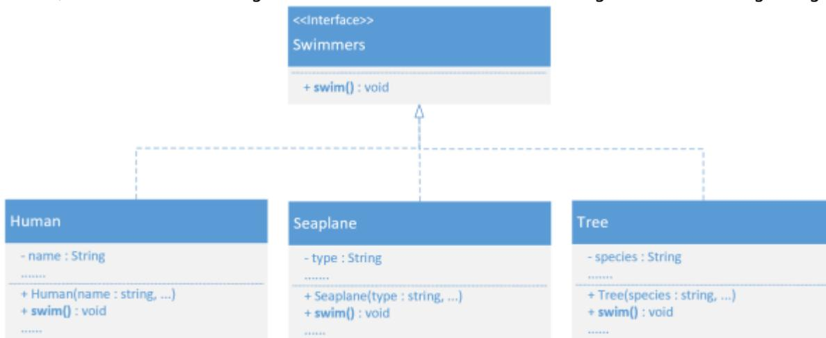
Abb. 7.3: Schnittstellen in UML
