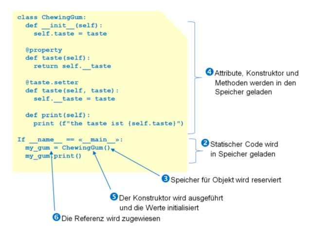
Der Aufbau im Speicher wird schematisch dargestellt.
