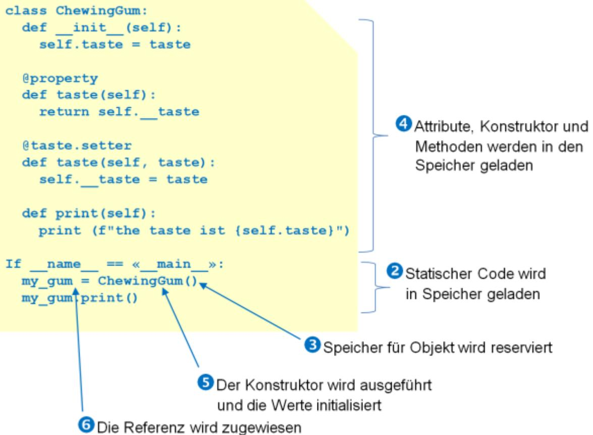
Der Aufbau im Speicher wird schematisch dargestellt.
