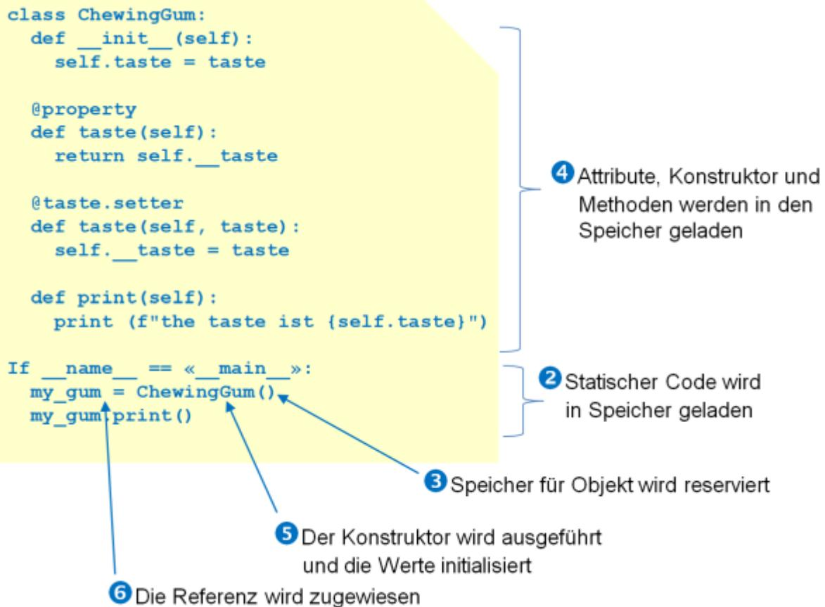
Der Aufbau im Speicher wird schematisch dargestellt.
