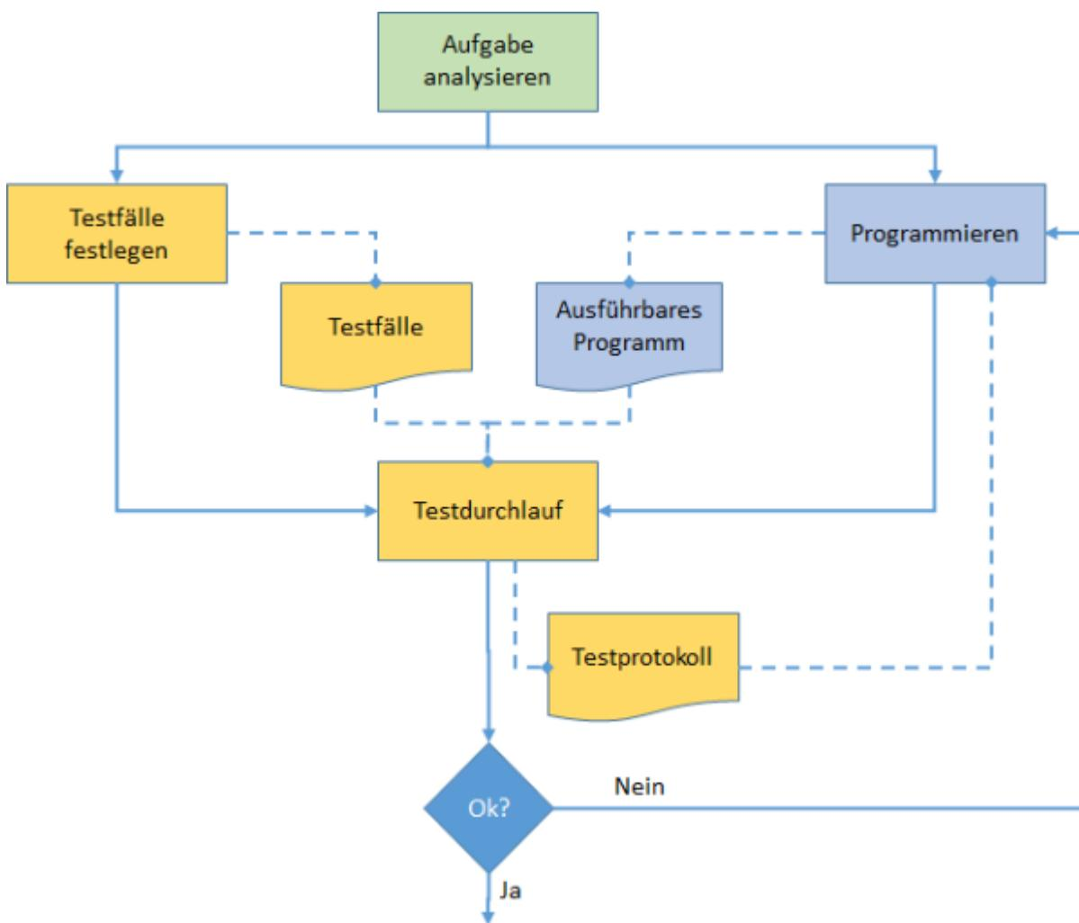
1. In der Analyse werden die Anforderungen an das Programm ermittelt. Diese Anforderungen dienen als Grundlage für die Erstellung der Testfälle und des Programms.
